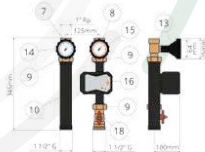
Fot. 2: Grupo de bombas DN 25 circuito no mixto de calefacción
